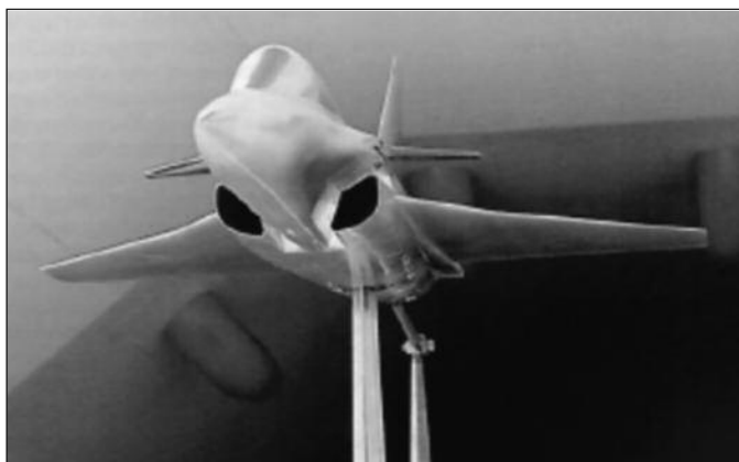
Модел авиона HA током испитивања у аеротунелу T-35
